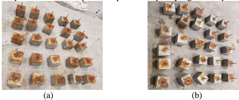
**Gambar 4. Kondisi Luar Spesimen (a) Spesimen Korosi Awal Tinggi (b) Spesimen Korosi Awal Rendah**
