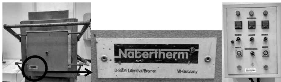
Gambar 2. Oven yang Digunakan untuk Pembakaran Kulit Kerang
