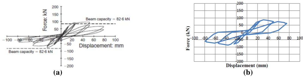
Gambar 15. Grafik Hasil dari Spesimen BS-L-300 (a) Grafik Hasil Eksperimen dan (b) Grafik Hasil Simulasi
