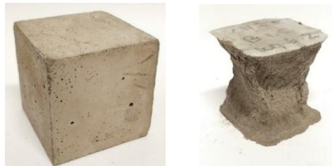
Gambar 2. Kondisi Mortar Sebelum dan Sesudah Pengujian Kuat Tekan
