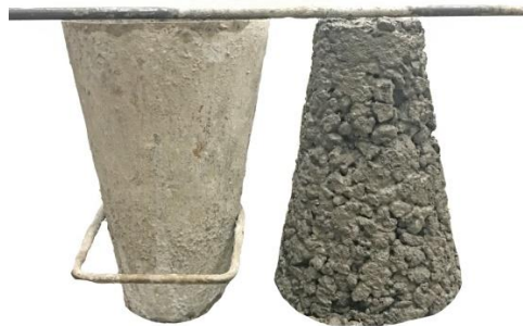
Gambar 6. Hasil Pengukuran Slump Beton dengan w/c 0.5, SP 0.6%; VMA 0.35%; dan V_p/V_v 101 %
