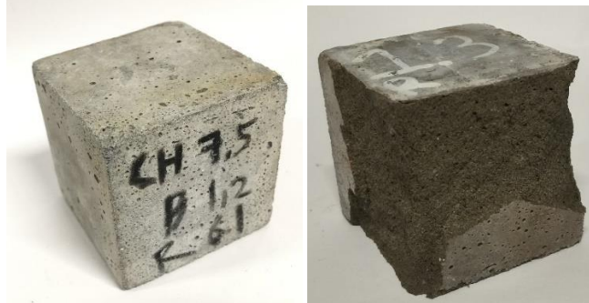
Gambar 2. Kondisi Mortar Sebelum dan Sesudah Pengujian Kuat Tekan
