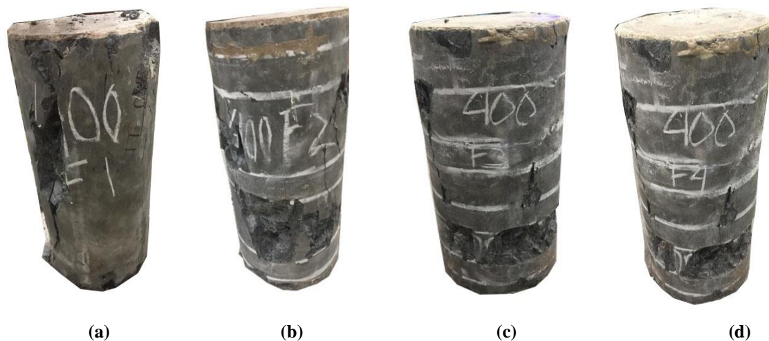
Gambar 7. Pola Keruntuhan (a) tanpa Clamp (b) dengan 3 Clamp (c) dengan 4 Clamp (d) dengan 5 Clamp
