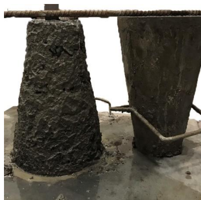
Gambar 6. Hasil Pengukuran Slump Beton dengan w/c 0.5 dan V_p/V_v 110 %
