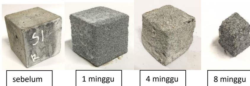
Gambar 3d. Perubahan Bentuk Mortar Semen
