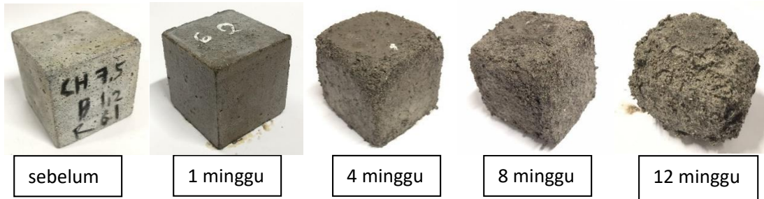
Gambar 3a. Perubahan Bentuk Mortar CH7,5B1,2
