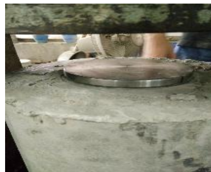
Gambar 4 Plat Diletakkan di Bagian Atas Spun Pile
