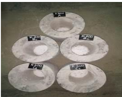
Gambar 3 Gabus Dimasukkan pada Bagian Bawah Spun Pile
