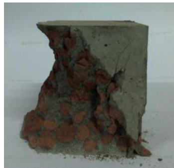
Gambar 3. Beton dari Agregat Ringan Geopolimer, Sebelum dan Sesudah Uji Kuat Tekan
