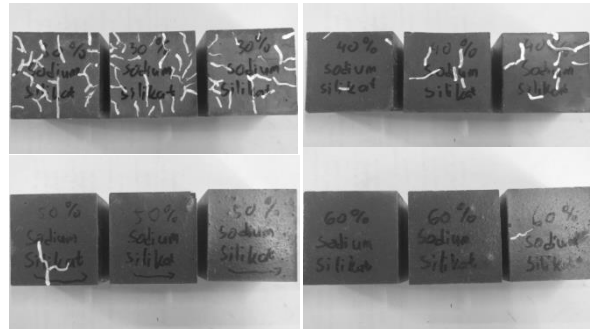
Gambar 1. Hasil Pencetakan Bekisting 5x5x5 cm 3 dan Area Retak Benda Uji
