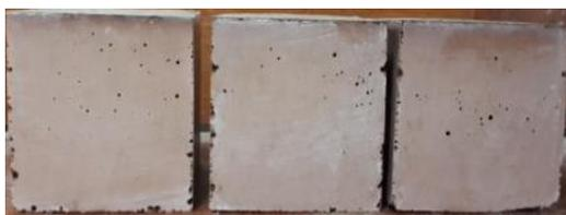
**Gambar 2. Contoh Benda Uji Tidak Retak dengan Penggunaan 4 Liter *Foam* pada Perbandingan *Foam Agent* : Air = 1 : 20****Tabel 11. Hasil Uji Kuat Tekan Umur 7 Hari, Berat Jenis, Absorpsi dan Stabilitas pada Perbandingan *Foam Agent* : Air = 1 : 20**
