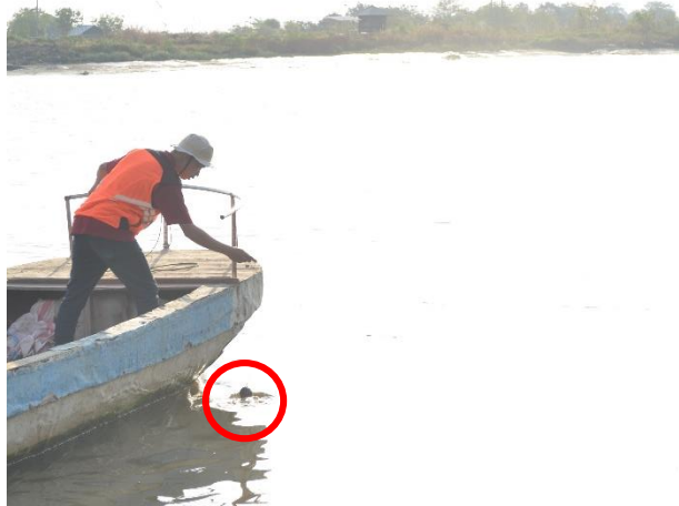
Gambar 2. Pengambilan Data Batimetri Menggunakan Sonar di Samping Perahu
