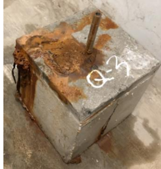
Gambar 4. Tipikal Tampak Visual Spesimen Setelah Diberi Korosi Awal
