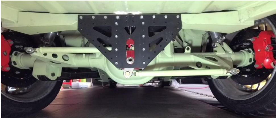
Gambar 1.1 Watt's link pada suspensi belakang Holden Torana
