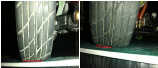
a. Roda kiri b. Roda kanan Gambar 3.6 Tapak Roda pada Lantai dengan Posisi Chamber 0^\circ dalam Keadaan Steering Belok
