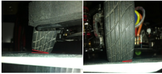
a. Roda kiri b. Roda kanan Gambar 3.4 Tapak Roda pada Lantai dengan Posisi Chamber -4^\circ dalam Keadaan Steering Belok
