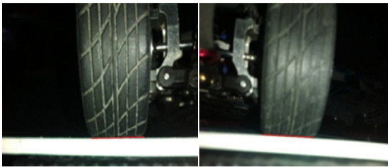
a. Roda kirib. Roda kanan Gambar 3.5 Tapak Roda pada Lantai dengan Posisi Chamber 0^\circ dalam Keadaan Steering Lurus
