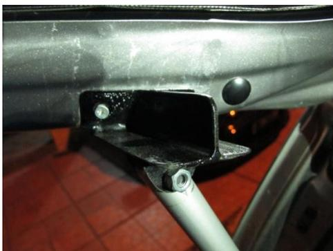
Gambar 7: Penerapan engsel pada pintu bagasi.
