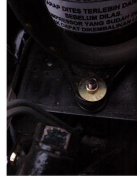
Gambar 5 : Gambar isolator dan redaman pada dudukan dan baut kompresor
