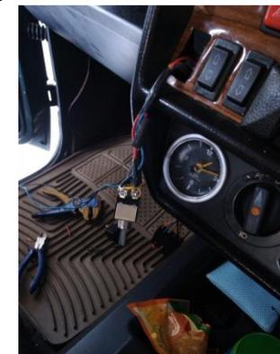
Gambar 13 : Gambar proses instalasi perkabelan switch standard to Inverter
