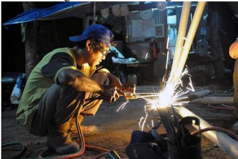
Gambar 3 : Gambar proses pembuatan dudukan kompresor dengan cara *welding*
