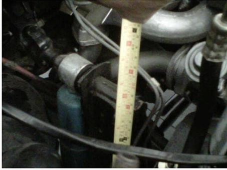
Gambar 2 : Gambar proses pengukuran untuk dudukan kompresor Hermetic
