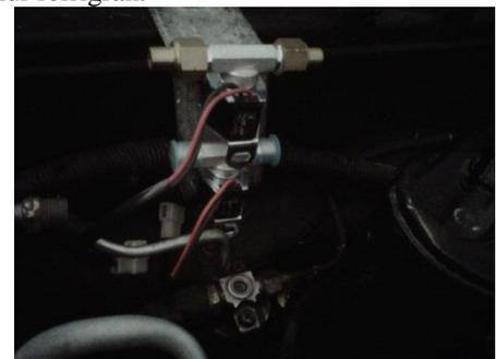
Gambar 7 : Gambar proses instalasi *Solenoid Valve*
