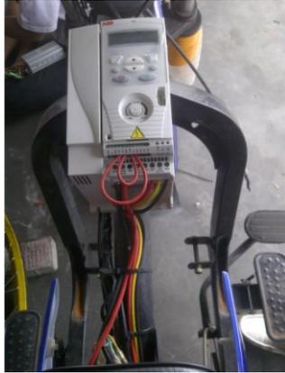
Gambar 10 : Perakitan *inverter* sekaligus kontroler
