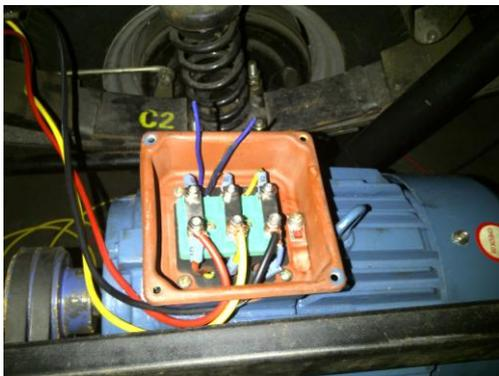
Gambar 11 : Perakitan suplai energi pada motor listrik
