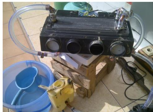
Gambar 12. Heat exchanger dingin yang sudah dirakit
