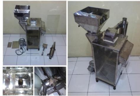
Gambar 2. Hasil Pembuatan Air Classifier
