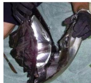
Gambar 6. Proses Pembongkaran *Headlamp* dengan *Heatgun*
