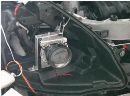
Gambar 9. Kondisi *Headlamp* Setelah Dilakukan Modifikasi
