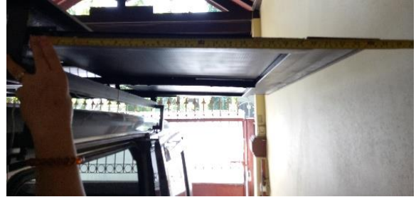
Gambar 3.2 Uji panjang penutup tenda elektrik
