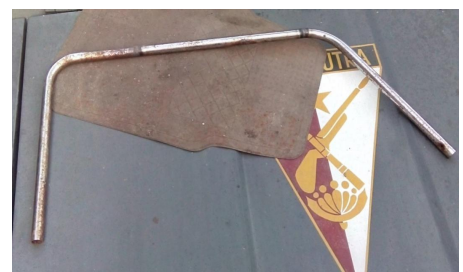
Gambar 13. Pipa besi setelah di bengkokkan
