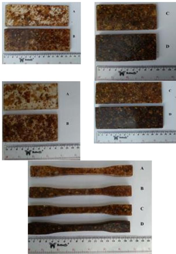
Gambar 1 Spesimen uji tarik, tekuk dan impact
