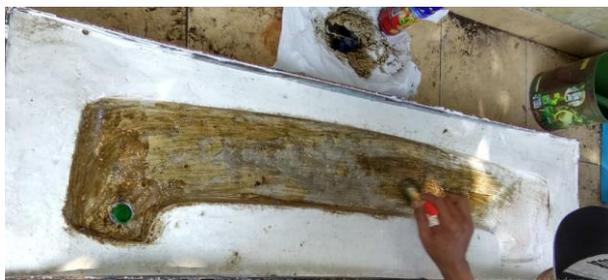
Gambar 4 Proses pembuatan cetakan
