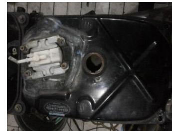
Gambar 2.2 Tangki bahan bakar setelah dimodifikasi
