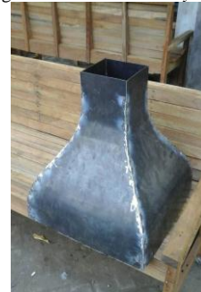
(b) contraction cone yang terbuat dari besi dengan tebal 2 mm
