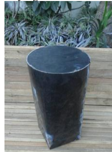
(c) diffuser yang terbuat dari besi dengan tebal 2 mm.
