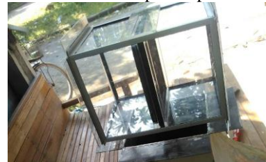
(a) test section yang terbuat dari bahan Acrylic dengan tebal 2 mm
