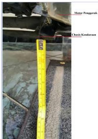
Gambar 13 Pengukuran *Ground clearance* Kendaraan
