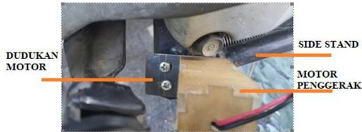
Gambar 13 Pemasangan Motor penggerak pada Sepeda Motor
