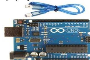
Gambar 12 Mikrokontroler Arduino Uno R3 Sumber listrik pada mikrokontroler arduino ini
