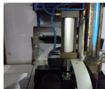
Gambar 8. Lift suspension yang diterapkan pada chassis monocoque model
