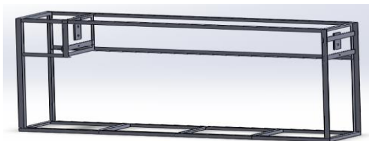
Gambar 5. Perancangan frame alat peraga ukuran 180cm x 40cm x 100cm
