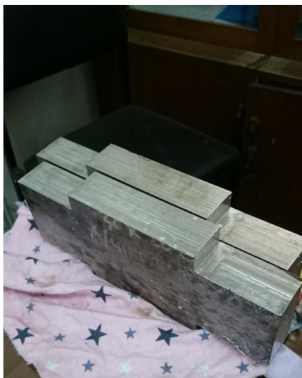
Gambar 2. Hasil pemakanan aluminium dengan proses Milling
