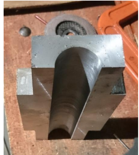
Gambar 3. Hasil pemakanan aluminium dengan proses turning
