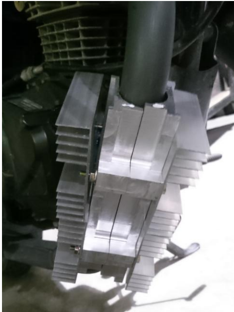
Gambar 4. Sistem generator yang menempel pada motor
