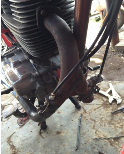
Gambar 7. Pemasangan Knalpot Dualsound Dari Exhaust Port
