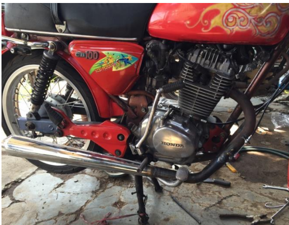
Gambar 8. Posisi Pemasangan Knalpot Dualsound
