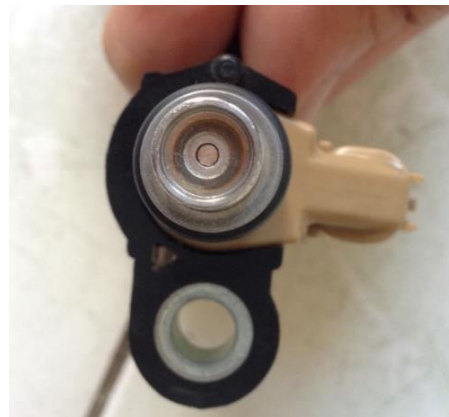
Gambar 3.3 Injektor yang telah di modifikasi
