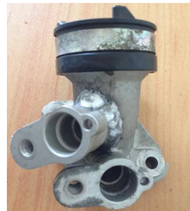
Gambar 3.4 Intake manifold yang telah dimodifikasi
