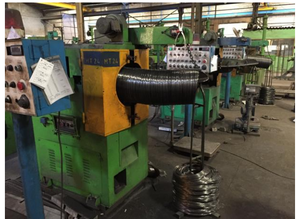
Gambar 1. Posisi gulungan kawat pada mesin coiler dan boom sebagai penampung kawat [9]
