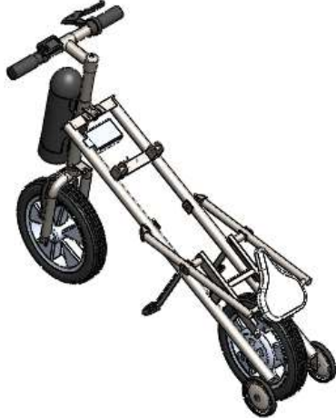
Gambar 6. Posisi Saddle Post dalam Kondisi Sepeda Dilipat
