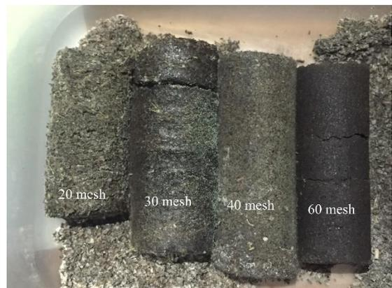
**Gambar 6 Briket dengan tekanan press 10 bar (1MPa)**
