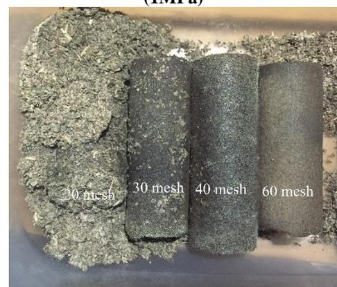
**Gambar 7 Briket dengan tekanan press 20 bar (2MPa)**
