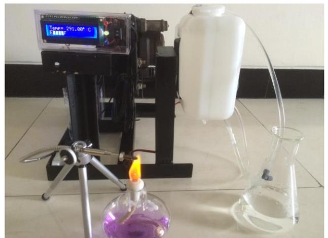
Gambar 21. *Set up* pengujian sistem pendingin rem paksa
