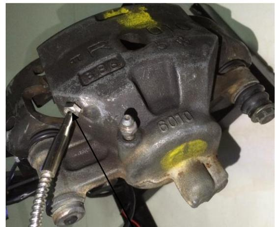
Gambar 17. Pemasangan *thermocouple* pada kaliper
