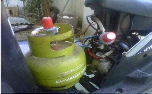
Gambar 9. Konverter kit yang telah di buat
