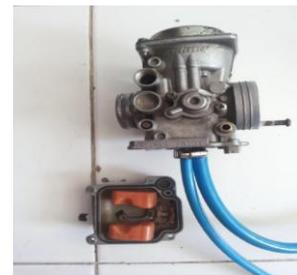
Gambar 2. Bagian Sisi bawah karburator dan Pelampung bensin
