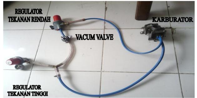
Gambar 6. Perakitan Dua Regulator Pada Karburator
