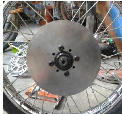
Gambar 9. Cakram tanpa Lubang Ventilasi
