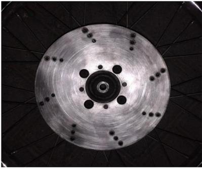
Gambar 11. Cakram dengan Lubang Ventilasi pada Kemiringan 30°
