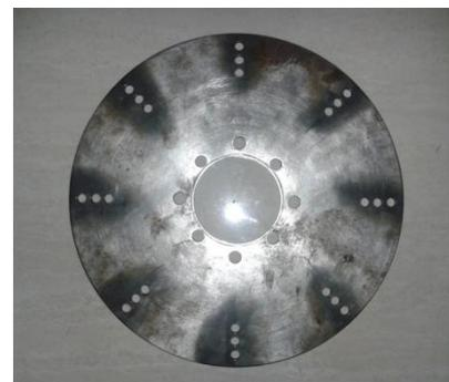
Gambar 10. Cakram dengan Lubang Ventilasi pada Kemiringan  $0^\circ$
