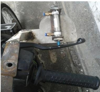
Gambar 7. Silinder Pneumatik
