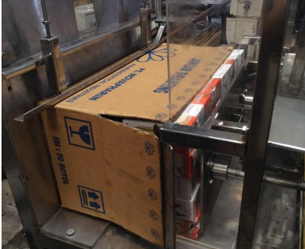
Gambar 7. Foto Proses Produk Dimasukkan Dalam Kardus
