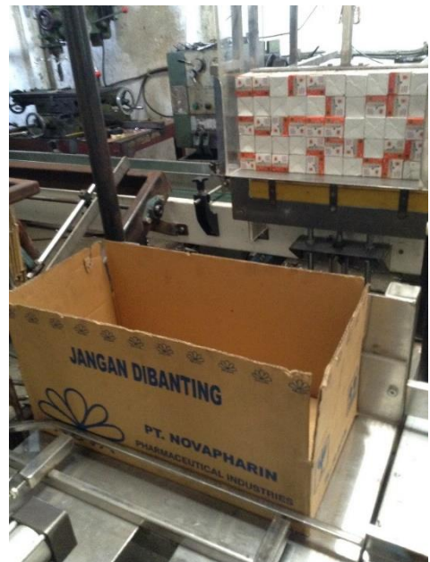
Gambar 6. Foto Proses Pemasangan Kardus yang Telah Siap di Gawang
