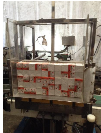
Gambar 5. Foto Proses Produk Diangkat ke Atas Melewati Penahan Produk
