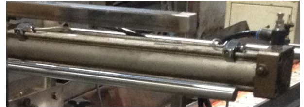
Gambar 20. Contoh Peletakan Sensor Reed Switch pada Pneumatik
