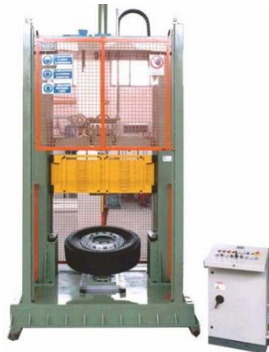
Gambar 1. Mesin Penguji Dengan Standar SAE J175[8]
