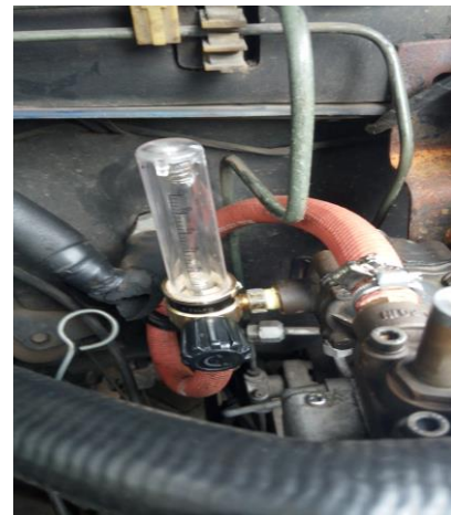
Gambar 5. Aplikasi Flowmeter pada regulator
