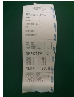
Gambar 15. Hasil pengujian opasitas gas buang dengan DPT
