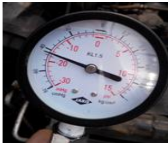
Gambar 13. Pengujian back pressure setelah dipasang DPT
