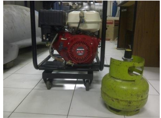
Gambar 5. Pemasangan saluran bahan bakar tambahan pada karburator
