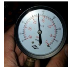
Gambar 19. Pengukuran tekanan vakum di intake manifold pada Catalytic Converter II
