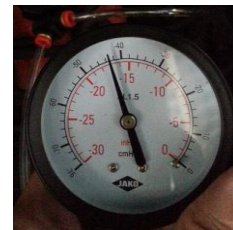
Gambar 20. Pengukuran tekanan vakum di intake manifold pada Catalytic Converter III
