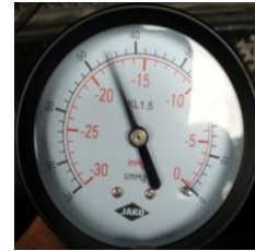
Gambar 18. Pengukuran tekanan vakum di intake manifold pada keadaan standard
