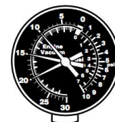
Gambar 16. Gambar Pembacaan Vacuum Gauge
