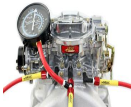
Gambar 13. Pemasangan vacuum gauge
