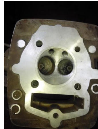
Gambar 15. Kepala silinder sesudah modifikasi tampak dari bawah
