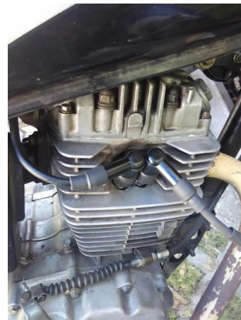
Gambar 16. Hasil akhir modifikasi sistem pengapian dua busi
