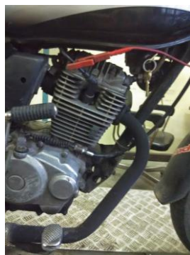
Gambar 11. Pemasangan kabel pembacaan RPM pada kabel busi
