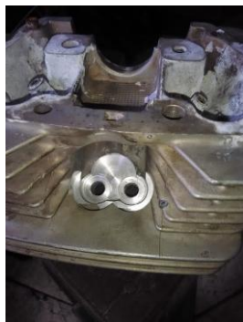
Gambar 14. Kepala silinder sesudah modifikasi tampak dari atas
