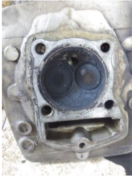
Gambar 13. Kepala silinder sebelum modifikasi
