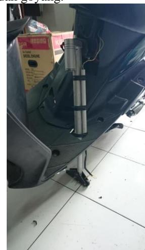
Gambar 2. Actuator Yang di Modifikasi.
