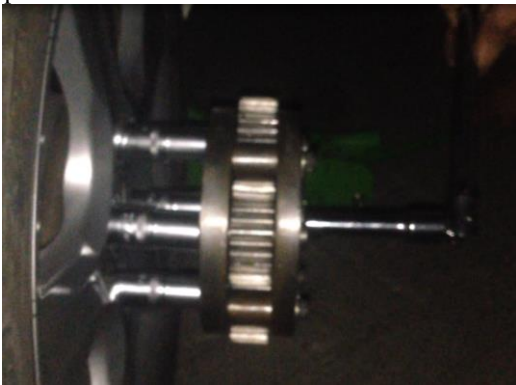
Gambar 11. Pengujian dengan menggunakan kunci stang panjang
