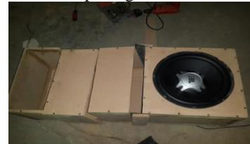
**Gambar 13. Hasil Pemotongan untuk dijadikan Sekat 1 dan Sekat 2**
