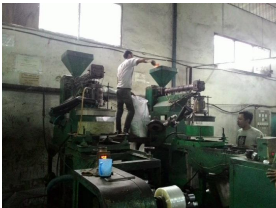
Gambar 1. Proses memasukan biji plastik
